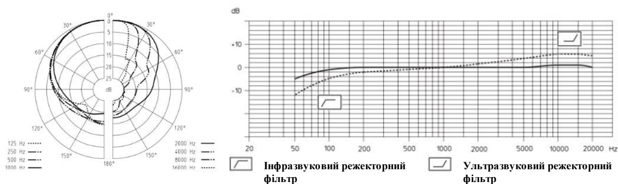
Рис.3.2. Діаграма спрямованості та частотна характеристика Sennheiser MKH 70-1
