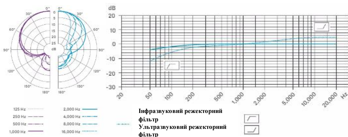
Рис.3.5. Діаграма спрямованості та частотна характеристика Sennheiser MKH 60-1
